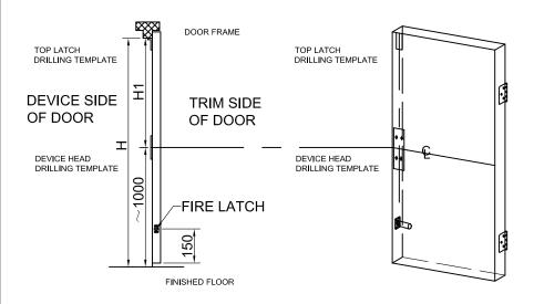
2) PREPARE HOLES FOR DEVICE, STRIKES AND PULLMAN.AND AUXILIARY FIRE LATCH
