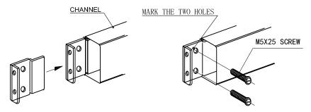
4) INSTALL TOP STRIKE, AND THEN INSTALL PULLMAN LATCH BODIES TO ENSURE THAT THE LATCH BOLTS ENGAGE SECURELY TO THE STRIKE.
